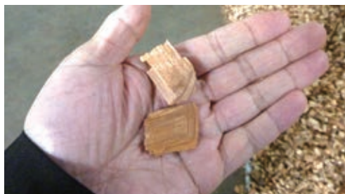
霧島木質発電所(木質チップ)
