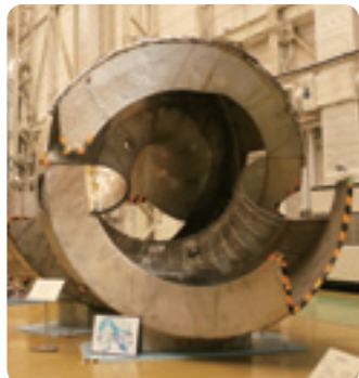
■ プラズマ真空容器の実物モデル。一億度の高温プラズマが閉じ込められます。
